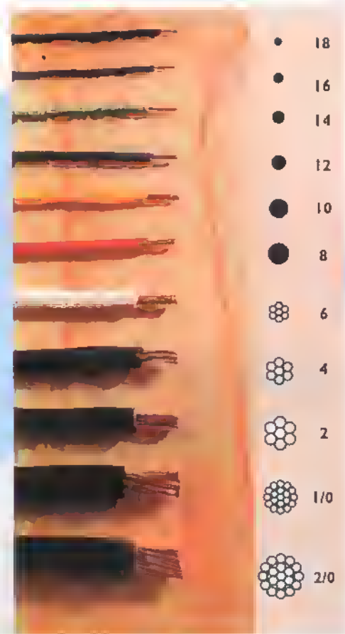
Figura 3.9. Calibre de los conductores
